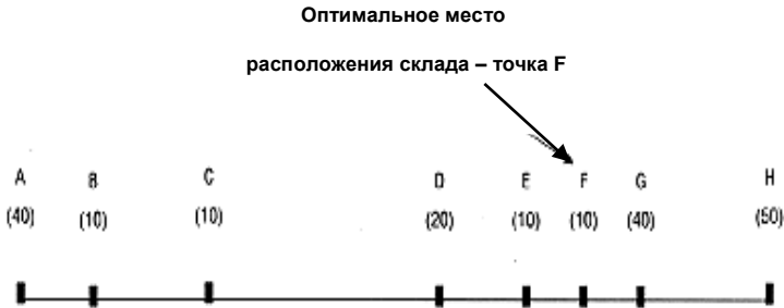
Рис.2.8 Определение оптимального места расположения склада на участке обслуживания методом пробной точки
